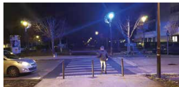
Une nouvelle signalisation, projecteur carré souvent de couleur bleue, a été installée sur certains passages piétons. Objectif : rendre visible les piétons dans l'obscurité.
