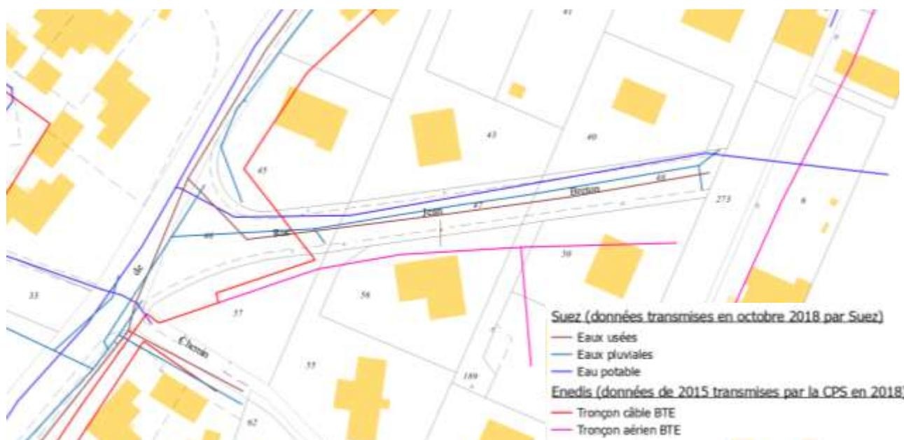
Figure 4 : Plan des réseaux de la rue J. Breton
